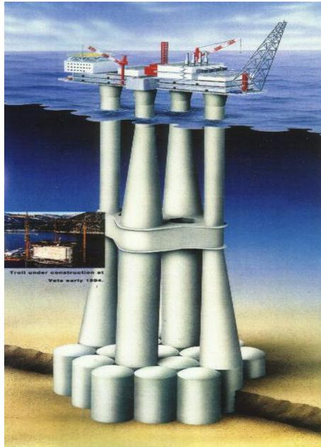
FIGURA 2.4 - Plataforma Fixa de Gravidade
