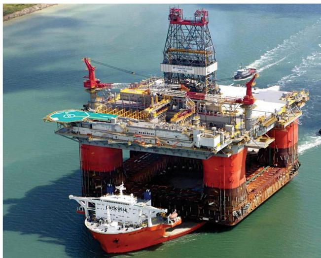
FIGURA 4.1 - Transporte de uma plataforma semi-submersível por Heavy Lift
