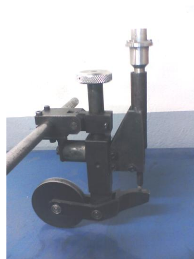
Figura 17: Mecanismo utilizado para o medição do sinal de espessura sobre o rolo NAR
