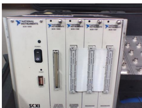
Figura 16: Equipamento de aquisição de dados utilizado, a figura da esquerda mostra o equipamento da National Instruments com o chassi SCXI1000 e os módulos de comunicação, a figura da direita mostra o equipamento criado pela Michelin para distribuição dos sinais analógicos
