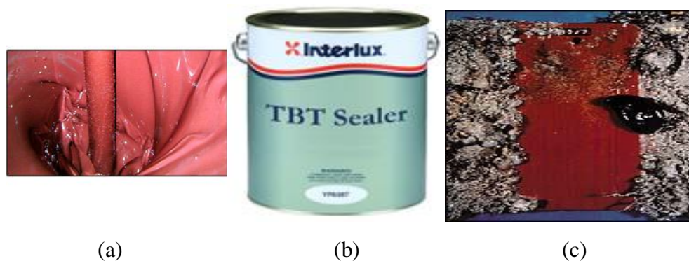
FIGURA 3.4 – (a) Biocida sendo misturado a tinta anti-incrustante (SCI, 2011); (b) Tinta a base de TBT (PSB, 2011); (c) Exemplo de placa de metal onde a parte pintada não foi afetada pela incrustação (ORTEP, 2011)
