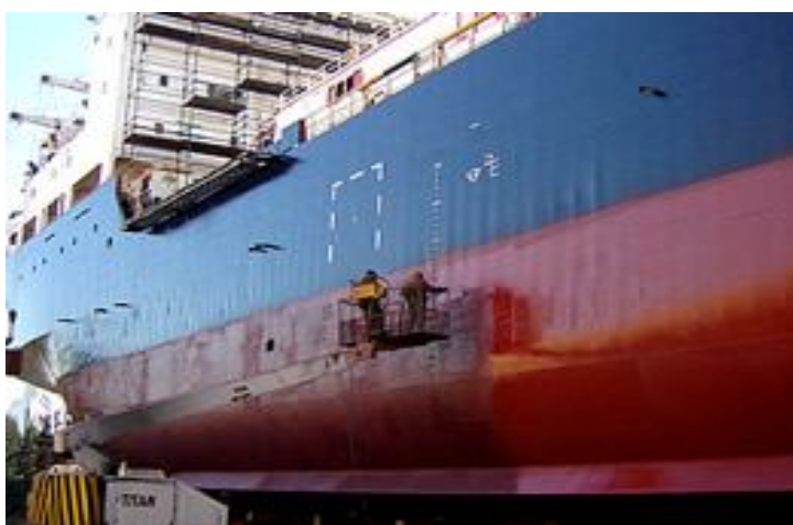
FIGURA 2.2 - Sistema de pintura de obras-vivas de embarcações (Weg, 2011)
