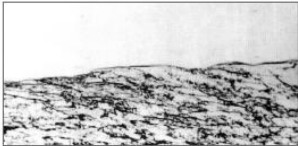
Figura 3 - Interface entre chapa de aço carbono revestida com aço inoxidável pelo processo de explosão, seguido de laminação a quente. Aumento 200X(SMITH, 2012).
