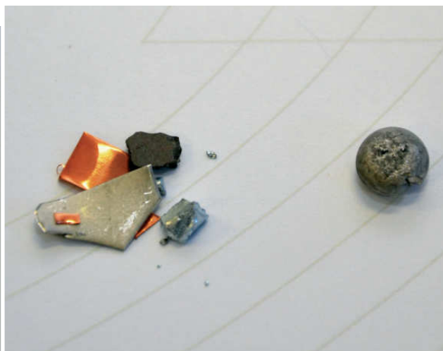
Antes (à esq.), amostras separadas de níquel, cobre, gálio e alumínio; depois, amostra resultante da fusão, em liga metálica
